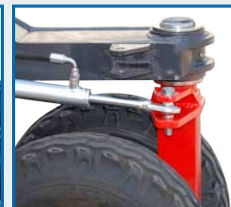
Ruota posteriore in fase di guida su strada Rueda trasera en fase de conducción en la carretera
